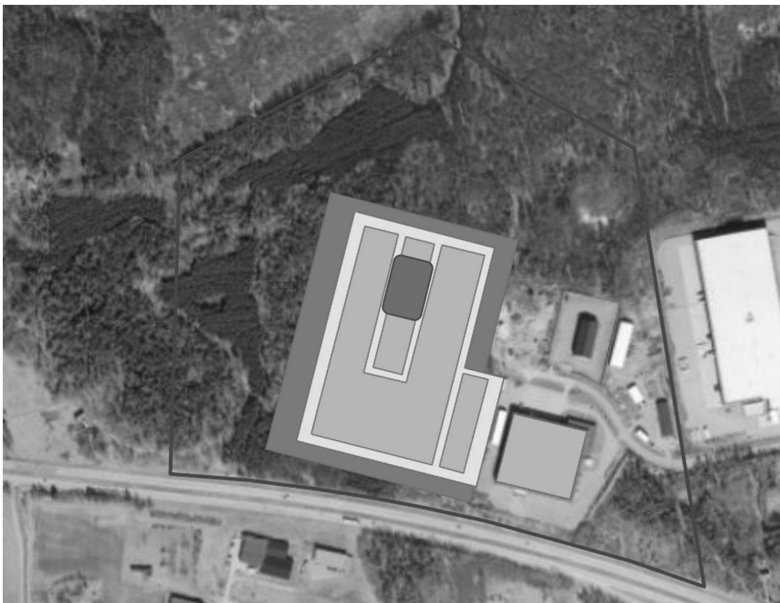
Figur 14. Schematisk bild av Seniors planerade verksamhet. Det högra huset är en befintlig byggnad där Senior etablerar verksamhet för beläggning av basfilm (tidigare benämnt Fas 1). Preliminär plats för lossning och förvaring av metylenklorid markerat med mörkblått. Observera att detta är en ungefärlig placering, den kan komma att ändras.
