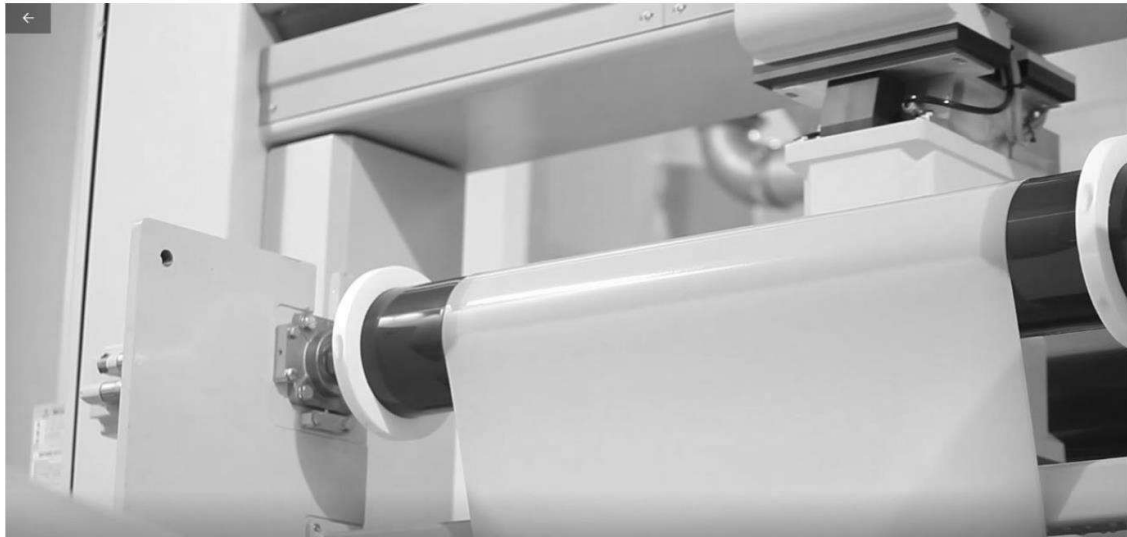
Figur 5. Polyetenfilm på rulle. Bild från Seniors tillverkning i Chanzhou i Kina.
